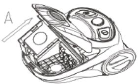
entnehmen Sie die Beutelhalterung mitsamt dem Staubbeutel aus dem Gerät. Ziehen Sie den vollen Staubbeutel aus der Beutelhalterung. Entsorgen Sie den Staubbeutel über den Hausmüll, sofern er keinen für den Hausmüll verbotenen Schmutz enthält.
