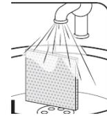
Spülen Sie den Filter unter fließend kaltem oder handwarmem Wasser gründlich aus (Abb. 30). Lassen Sie den Filter trocknen (ca. 24 Stunden bei Raumtemperatur).
